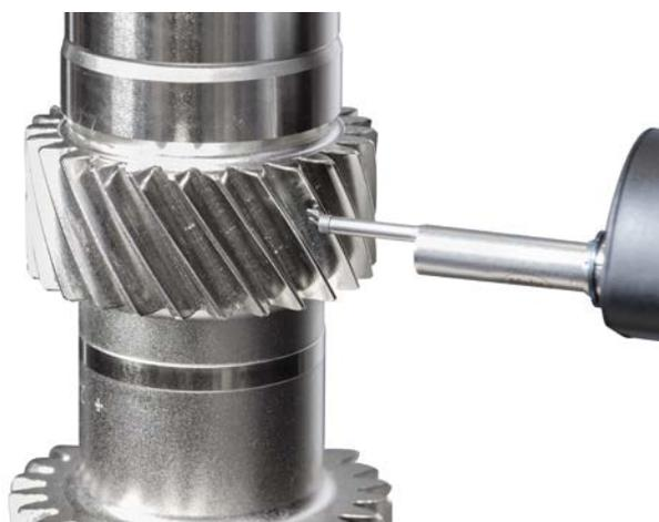
螺旋伞齿轮粗糙度测量
