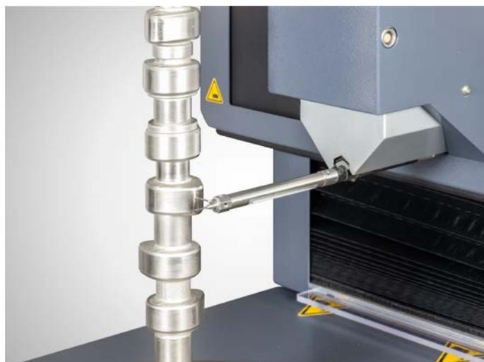
MarGear GMX 400 W: 使用星型测臂测量凸轮轴
