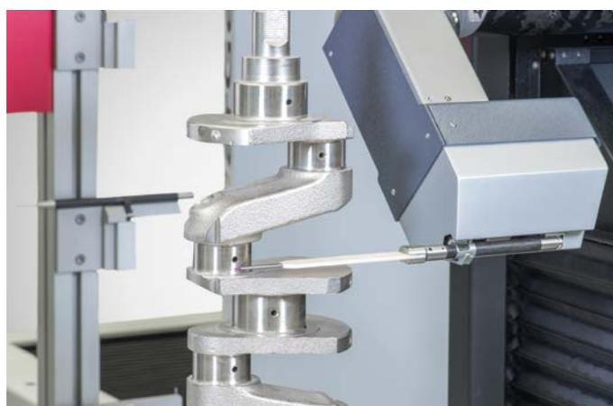
用于测量直径和形状的曲轴测针臂
